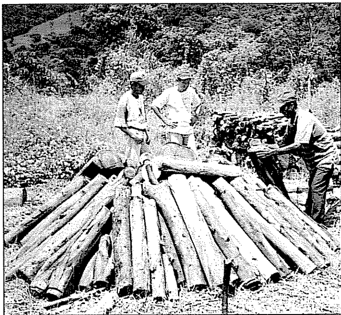
En la construcción del horno artesanal, la madera se va colocando en forma piramidal; luego se cubre con hojas y tierra (Foto: G Martínez).
