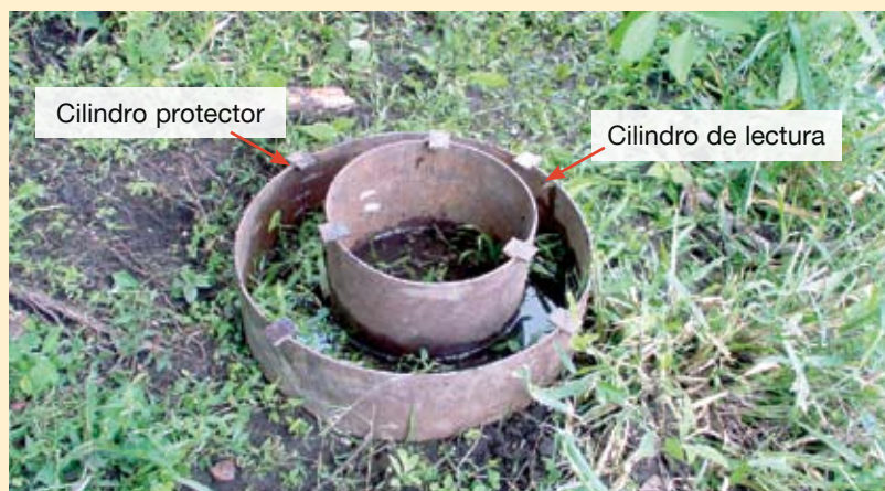
Figura 3. Prueba de infiltración con anillos concéntricos, subcuenca del río Jabonal, Costa Rica
