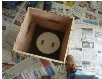
9) Colocar la cámara de combustión sobre los dos cuadritos de barro (quedando la perlita debajo de la cámara de combustión), con el hueco inferior (hueco de entrada de leña) de dicha cámara junto al lado delantero del molde de plywood y colocar el molde plástico alrededor de la cámara de combustión, cerrándolo de nuevo con el clip en el borde superior del molde plástico.
