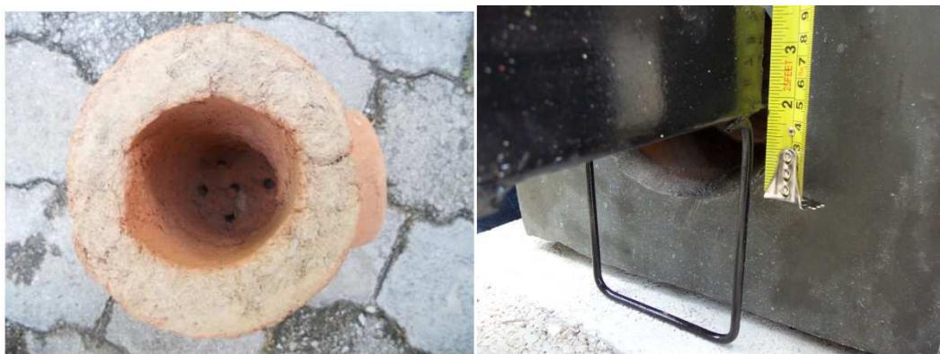
Figura 8: Cámara de combustión y ajuste del soporte de leña.
