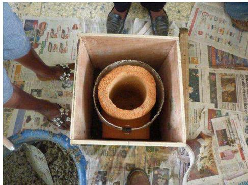
10) Cubrir con papel de periódico el hueco superior de la cámara de combustión para evitar que caiga mezcla. También introducir periódicos entre la cámara de combustión y el molde plástico con el fin de que no caiga mezcla en este espacio, pero tratando de mantener la misma distancia alrededor, entre la cámara y el molde plástico, de forma tal que el espacio alrededor de la cámara sea el mismo por todos lados y no quede el molde mas junto (el espacio más estrecho) en un lugar que en otro.
