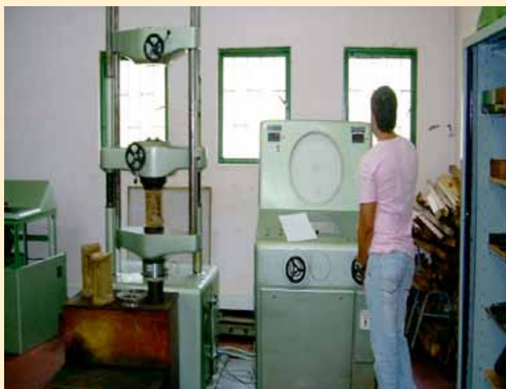
Figura 3. Máquina universal de ensayos WPM ZD 40, para determinar la resistencia al corte
