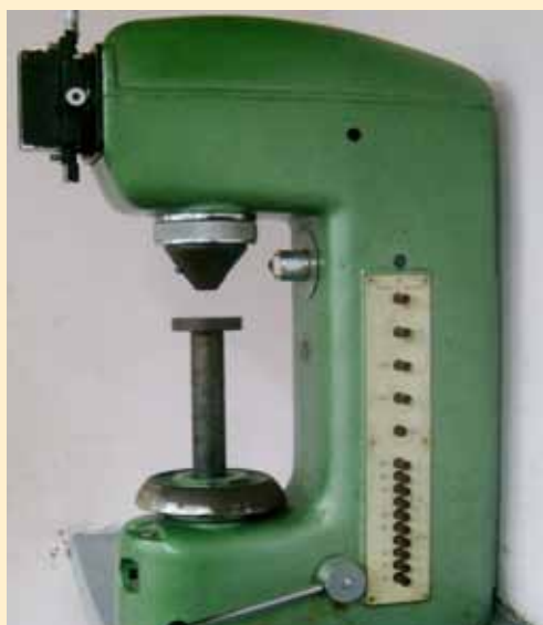
Figura 2. Escleroscopio HP-250 marca Werkstoffprüfmaschinen, para determinar la dureza Brinell
