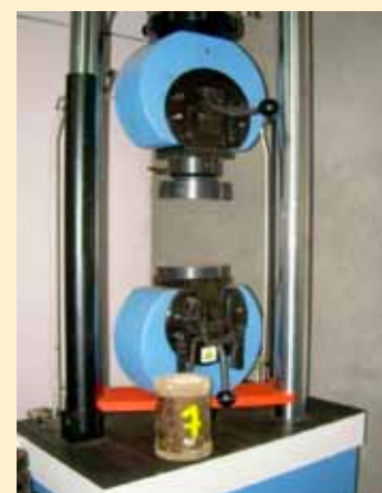
Figura 4. Máquina universal de ensayos Mod. UMIB-600-SW, para determinar la resistencia a la compresión
