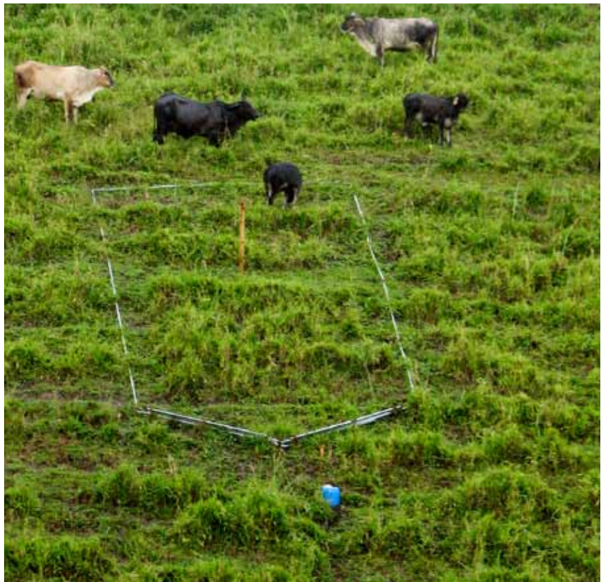
Foto 1. Parcela de escorrentía ubicada en pastura mejorada de la finca La Ramada, Quimbaya, Colombia
