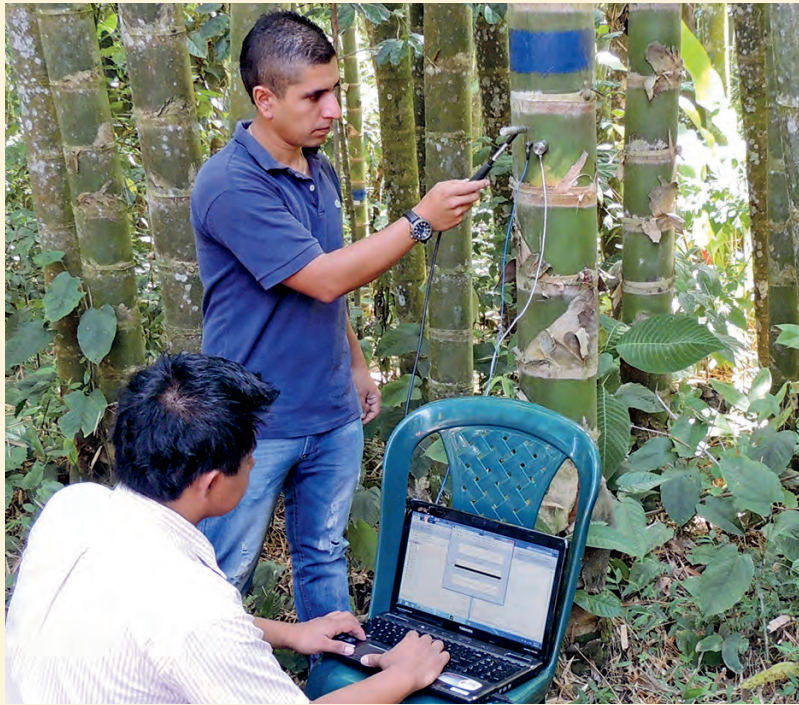
Figura 2. Adquisición de la señal del martillo de impacto y del acelerómetro
