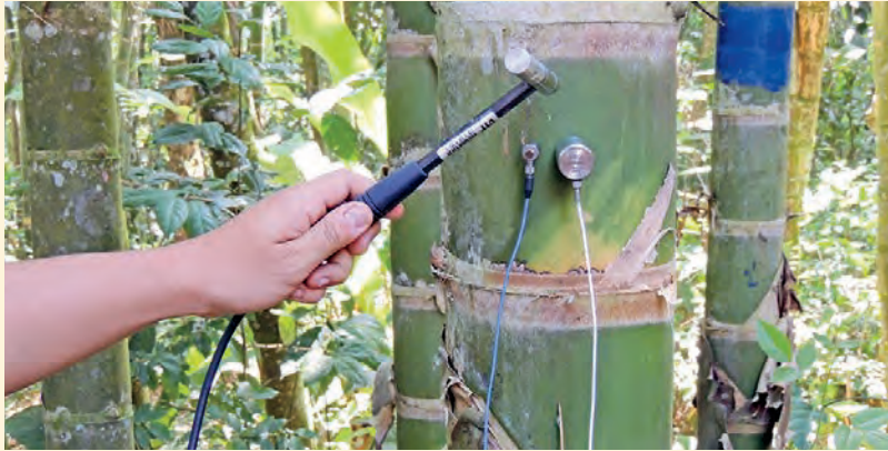
Figura 1. Prueba de impacto en el culmo de guadua
