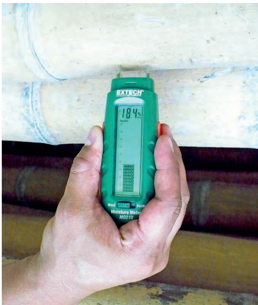
Medición del contenido de humedad en guadua almacenada.
