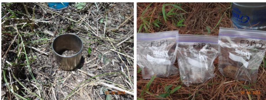
**Figura 15.** Cilindro medidor (izquierda) y muestras de suelo (derecha).
