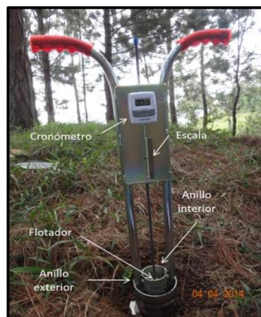
**Figura 14.** Infiltrómetro de doble anillo Turf-Tec.
