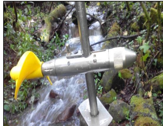
Figura 7. Mediciones de caudal por medio del molinete de hélice.
