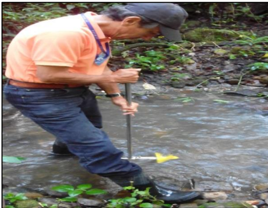
Figura 7. Mediciones de caudal por medio del molinete de hélice.
