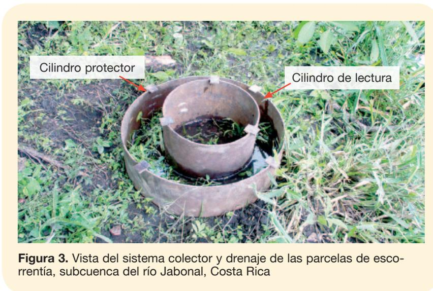
**Figura 3.** Vista del sistema colector y drenaje de las parcelas de escorrentía, subcuenca del río Jabonal, Costa Rica
