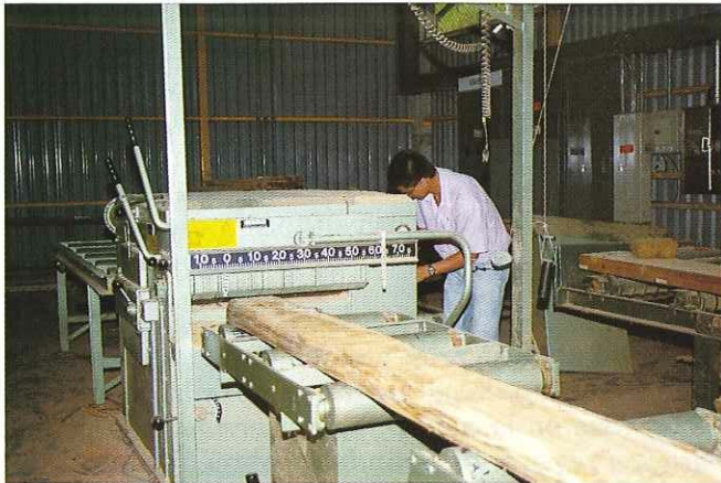
En la operación de reaserrío, se empleó una sierra circular múltiple. Los rendimientos reales estaban dentro de un nivel aceptable para el rango diamétrico de las trozas. (Foto: R. Jiménez).
