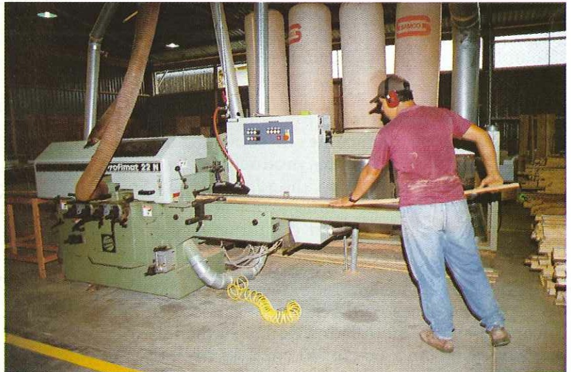
Con la madera de 14 mm de espesor, se procedió a la elaboración de tablilla machihembrada. (Foto: R. Jiménez).
