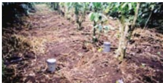
Tubos de incubación para medir la mineralización del N in situ en cafetales ( Coffea arabica ) en la finca Santa Fe en la Zona Sur de Costa Rica (foto: Héctor Ávila).
