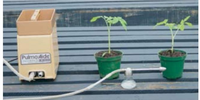
Figura 1. Atomizador DeVilbiss 15 conectado a una bomba de vacío (Foto: Guillermo Flores).
