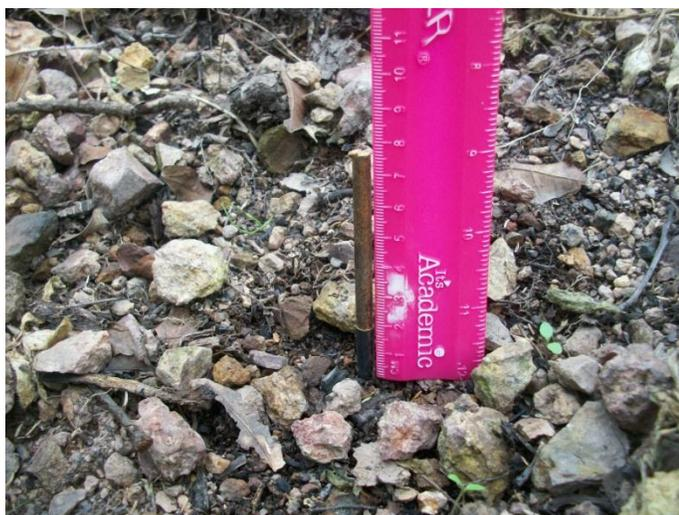
Figura 12. Varilla de medición de erosión laminar colocada en la parcela de observación
