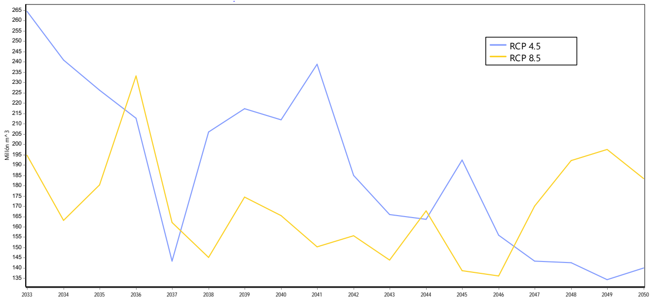
Gráfica 14 – Caudal estimado del río Teculután bajo los escenarios de RCP 4.5 y RCP 8.5, período 2033-2050.
