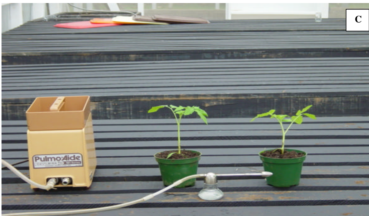
Figura 3. Atomizador DeVilbiss 15, conectado a una bomba de vacío, utilizado para asperjar las plantas de tomate.
