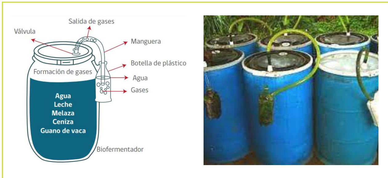
Figura 5.3. Componentes e ingredientes utilizados en un biofermentador para la producción de bioles Foto: Michael López - Herrera
