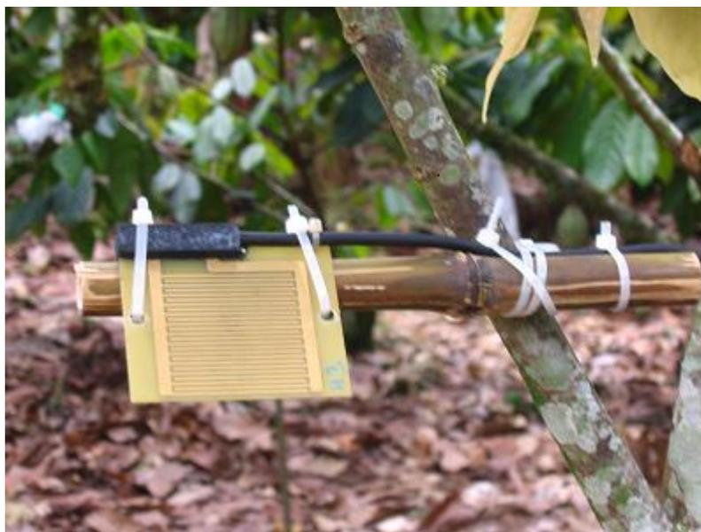
*Figura 3. Instalación de los sensores de mojadura.*
