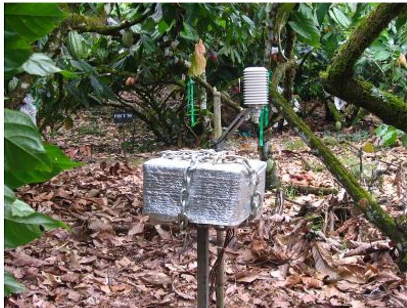
Figura 2. Estación Campbell junto a sensor de Humedad Relativa y Temperatura del aire.
