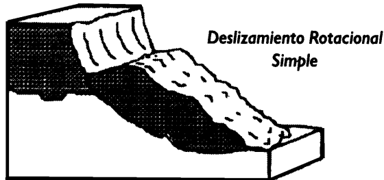
Figura 4 Deslizamiento rotacional simple
