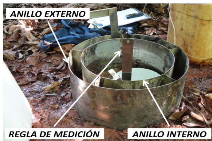
Figura 6. Anillos concéntricos para estimar la capacidad de infiltración.
