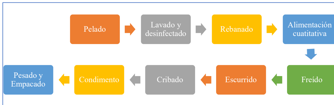
Figura 1. Flujo de producción de snacks de plátano, adaptado de TSHS, (2022) y Viera (2005).
