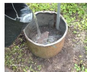
**Paso 4.** Vaciar los baldes suavemente en el interior del anillo, hasta que el nivel de agua quede entre 8 a 10 cm. Colocar el plato en el interior del anillo con el propósito de que el chorro no golpee directamente el suelo, porque se pueden alterar las propiedades de este.
