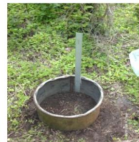
**Paso 3.** Colocar la regla verticalmente en el interior del anillo para así poder medir el nivel del agua. Un lugar recomendable para poner la regla es en la línea de la soldadura, porque esta es aproximadamente vertical y con la cinta adhesiva se puede fijar la parte de arriba de la regla, para que no se mueva.
