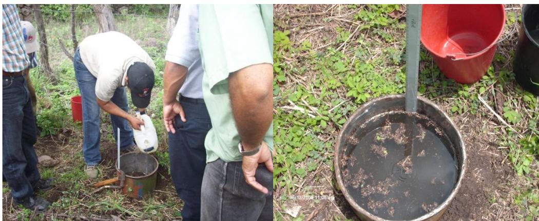
*Figura 10. Determinación de la capacidad de infiltración del suelo.*
