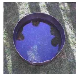
El método de anillo simple, aún cuando es uno de los experimentos más simples que se pueda realizar para medir tasa de infiltración, su precisión no deja de ser buena.
