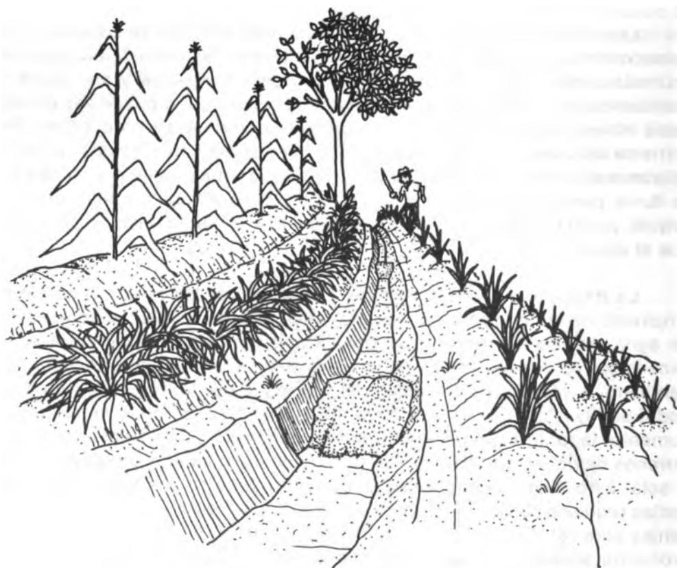
**Figura 6** Zanja de ladera, con lomillo y barreras vivas en su borde superior como complemento y protección. Nótese los cúmulos de tierra puestos como tabiques para detener el movimiento lateral del agua dentro de la zanja, fomentando la infiltración *in situ*.
