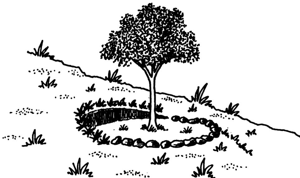
**Figura 7** Terraza individual con barrera viva en su extremo superior. El corte en la tierra permite que el agua percolando subsuperficialmente sea atrapada por la terraza.
