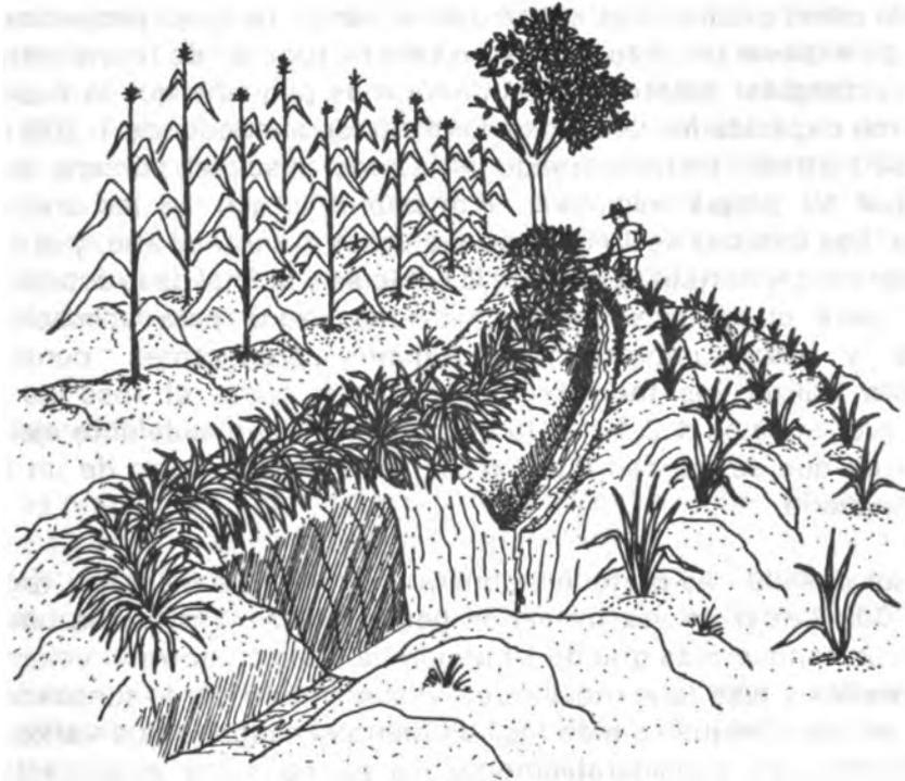
**Figura 9** Tanque de captación de agua alimentado por zanja de ladera con pendiente (en la figura no se muestra el revestimiento ni la tapa del tanque, que se discuten a continuación).
