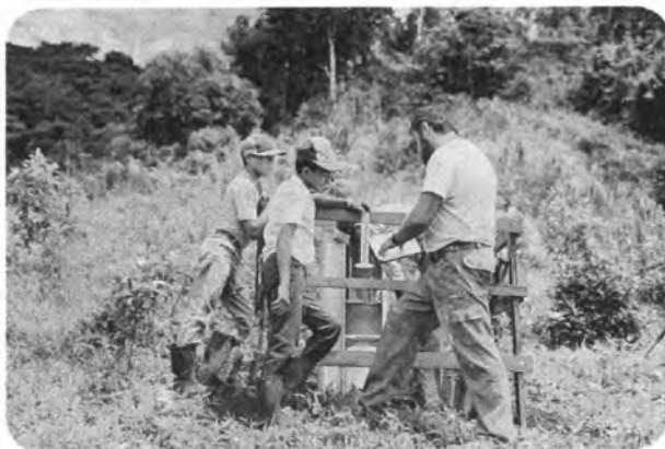
Instalación de un pluviógrafo, como parte de la red establecida en la Cuenca del Río Tuis, Costa Rica.
