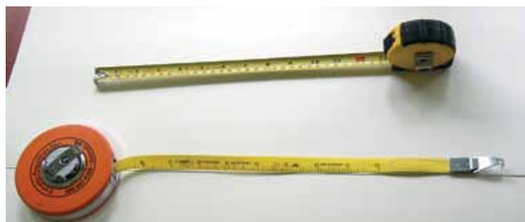
Figura 3.14. Instrumentos utilizados en la medición y cubicación de madera
