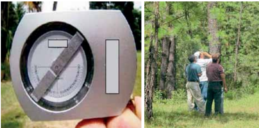
Figura 3.9. Vista de un hipsómetro y de personal realizando la medición de la altura del fuste por medio del instrumento
