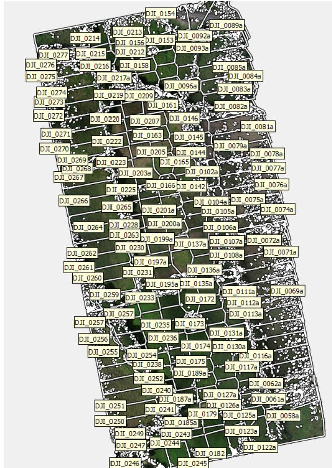
Figura 39. Ejemplo de visualización de un ortomosaico con líneas divisorias de reconstrucción (líneas de costura).
