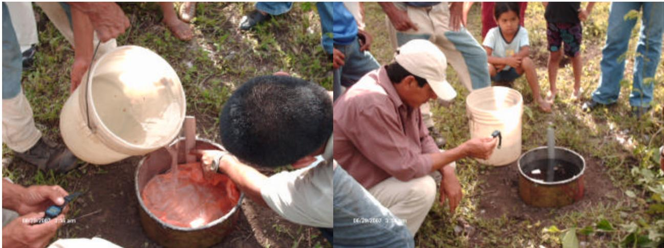
Figura 24: Determinación de la capacidad de infiltración del suelo
