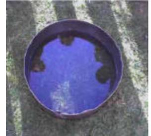
El método de anillo simple, aún cuando es uno de los experimentos más simples que se pueda realizar para medir tasa de infiltración, su precisión no deja de ser buena.
