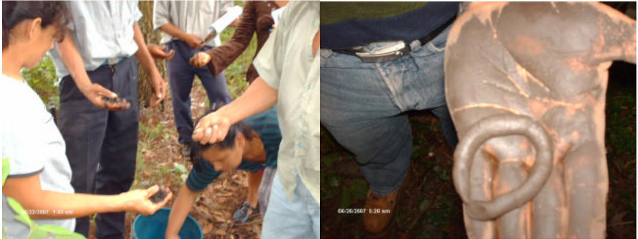
Figura 23: Determinación del tipo de suelo al tacto
