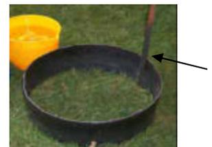
**Paso 4.** Vaciar los baldes suavemente en el interior del anillo, hasta que el nivel de agua quede entre 8 a 10 cm. Colocar el plato en el interior del anillo con el propósito de que el chorro no golpee directamente el suelo, porque se pueden alterar las propiedades de este.
