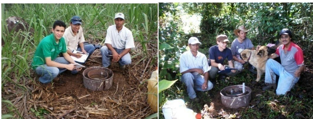
Posteriormente, se colocó una la regla graduada para las mediciones, y una tela para evitar la compactación, llenando agua en primer lugar al anillo exterior y luego al anillo interior, momento en el cual inicia las mediciones realizadas a diferentes intervalos de tiempo (1, 2, 3, 4, 5, 9, 10, 30, 45, 60, 90, 120 minutos) que fueron registrados en la tablas elaboradas para tal fin, aquí un ejemplo de toma de registros en El Silencio
