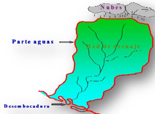
Figura 1. Esquema de una cuenca hidrográfica.
