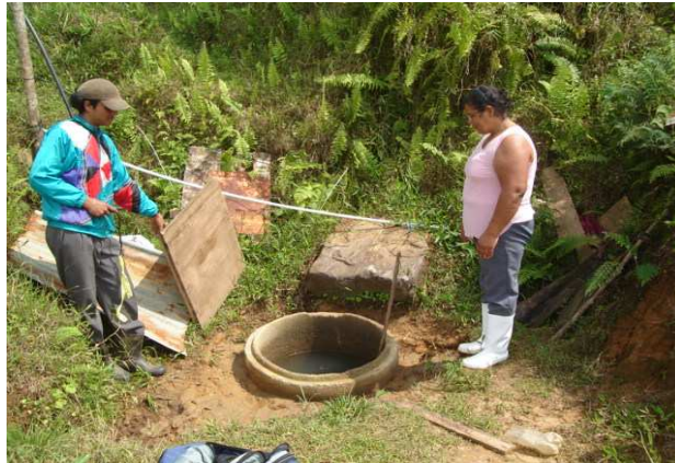
Foto 3. Medición de la profundidad del pozo
