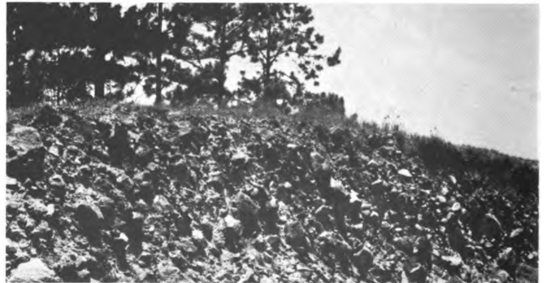
Fig. 13. Ignimbrita riolítica, muy fragmentada. Las tobas soldadas se fragmentan mecánicamente por los esfuerzos tectónicos a que han sido sometidas, ese comportamiento favorece más la infiltración que el flujo superficial.
