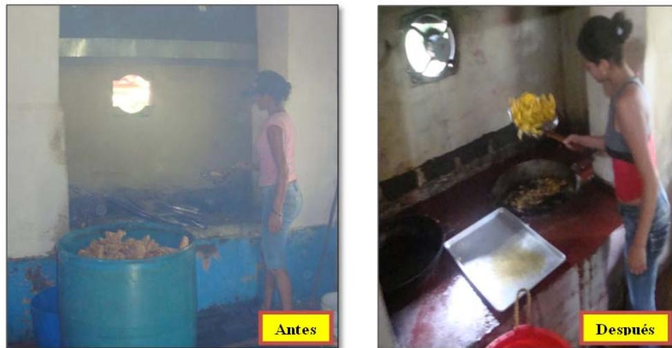
Figura 10. Área de freír (fogones), antes y después de la implementación de las 5S
