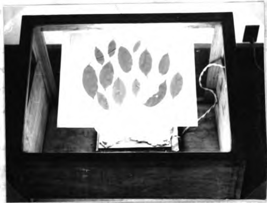
Figura 3. Aparato utilizado para "fotografiar" las hojas de cafeto en papel oxálico. En la presente se observa una hoja de papel oxálico ya impresionada.-
