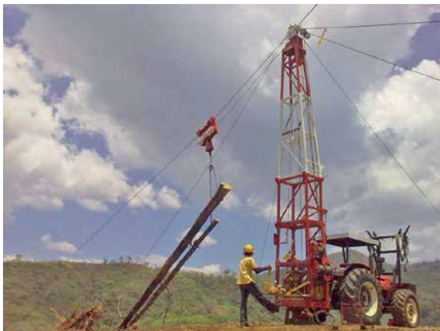
Figura 17.2. Sistema aéreo para el transporte de trozas en la plantación de Carrillo, Guanacaste. Foto: Folkert Kottman
