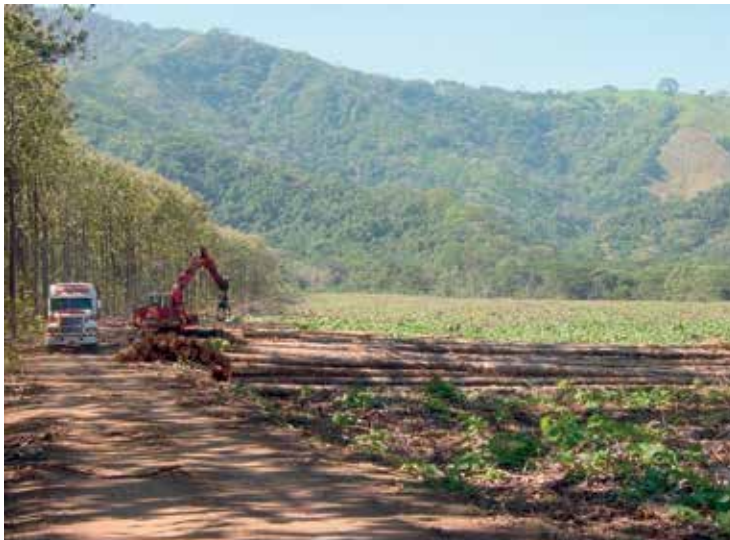
Figura 17.3. Cargador de trozas y camión listo para el transporte de trozas aprovechadas en el margen derecho del camino al patio de acopio de Palo Arco. Foto: Folkert Kottman
