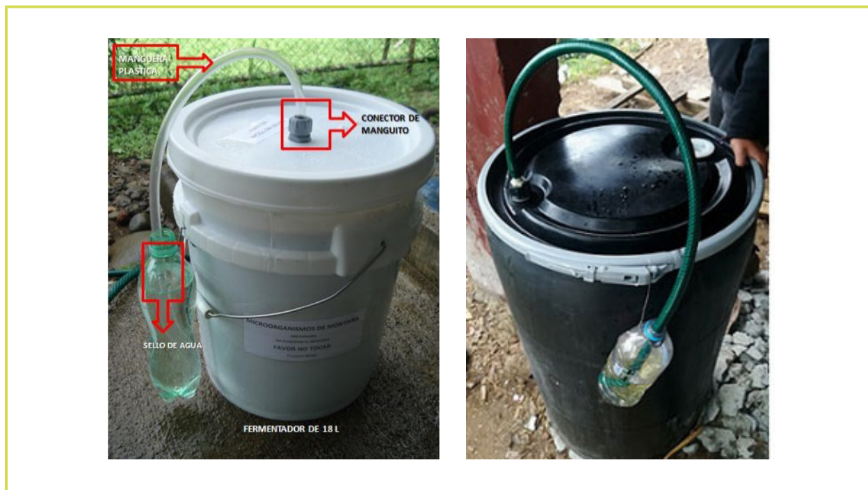
Figura 4. Diseños de tapas de contenedores con biofermentos para la salida de gas
