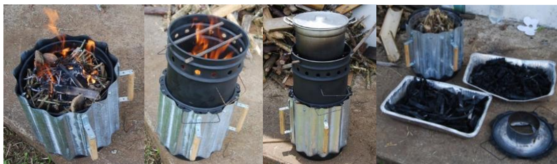
Figura 4. Proceso de combustión, montaje y cocción en la Estufa Finca, biocarbón como producto final. Fuente: Archivo personal, 2012.
