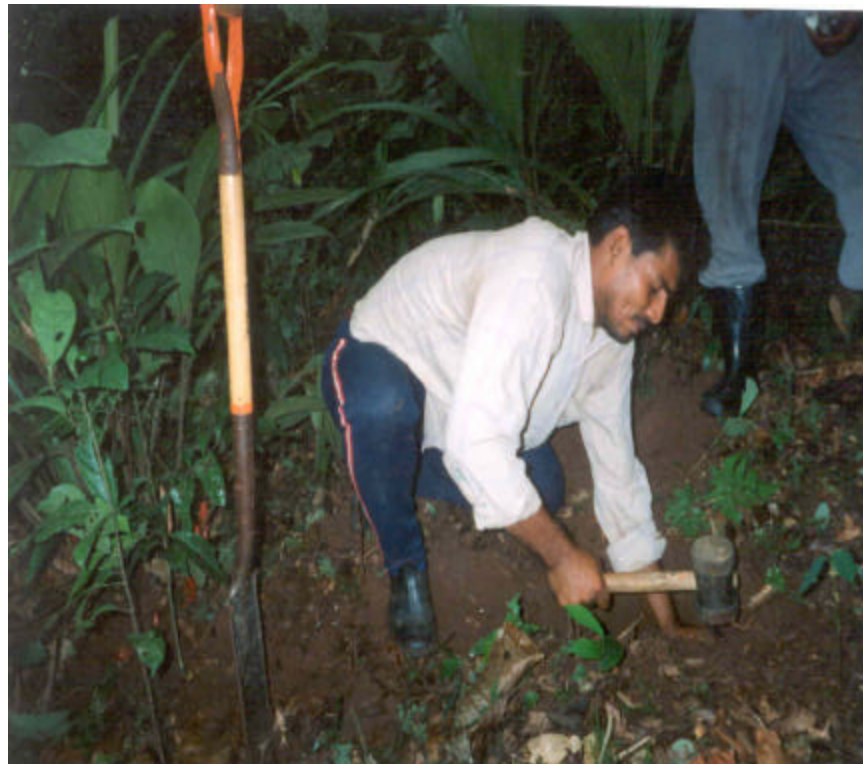
Extrayendo muestra de suelo para densidad aparente mediante el uso del cilindro
