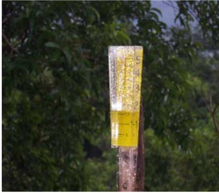
Figura 10. Tipo de pluviómetro colocado sobre las parcelas de escorrentía
