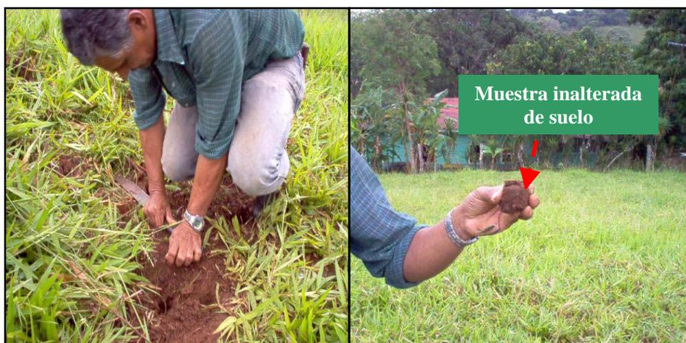
Figura 15. Toma de muestras inalteradas del suelo tomadas para la estimación del contenido de humedad
