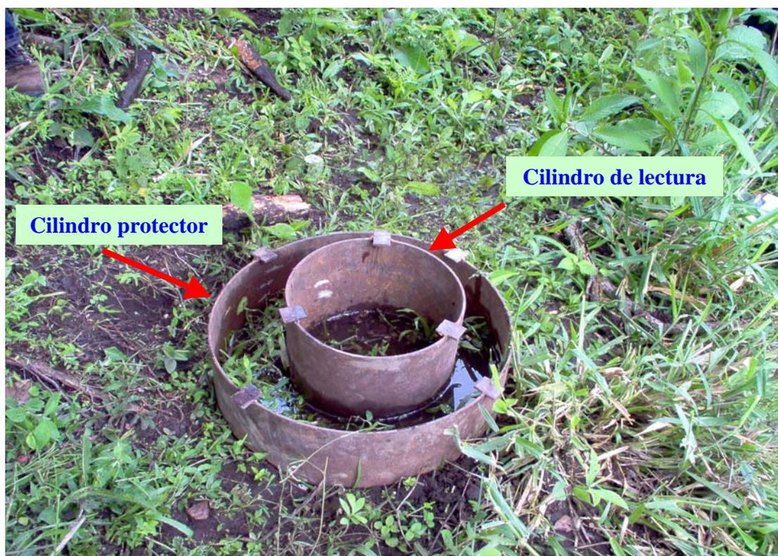
Figura 12. Anillos concéntricos para estimar infiltración
