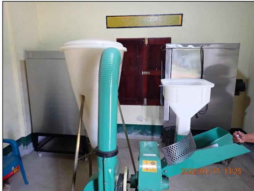
**Figura 46:** Máquina de molido de la semilla de ramón en FORESCOM.
