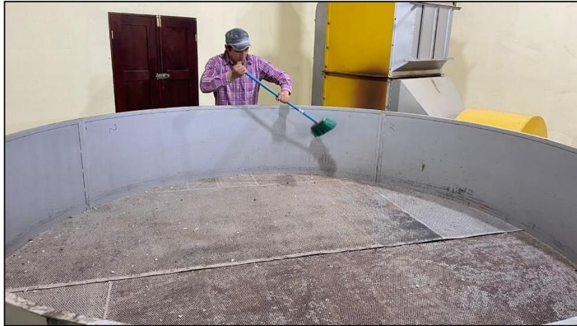
**Figura 43:** Hornos de secado para la semilla de ramón en FORESCOM.
