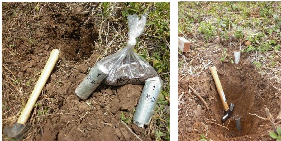
*Figura 3 (izquierda). Bolsa con muestra para análisis y cilindros para determinar densidad aparente del suelo en las áreas de recarga hídrica de las nacientes.*
