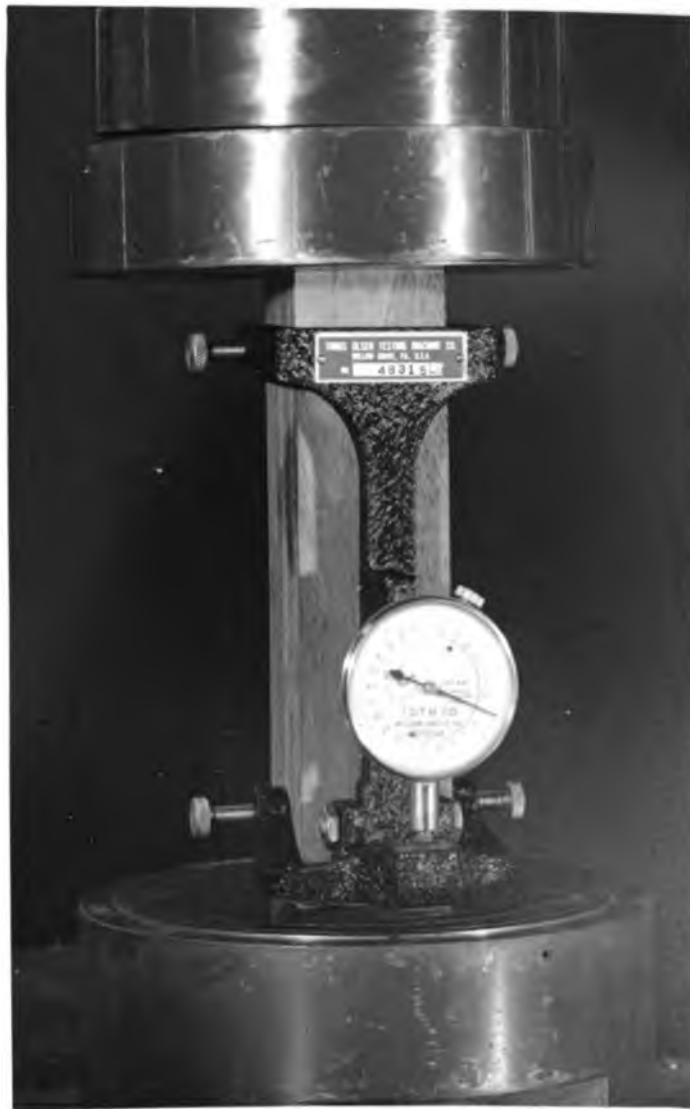
Fot. 5.- Compresómetro adaptado a la muestra sometida a la prueba de compresión paralela a las fibras.
