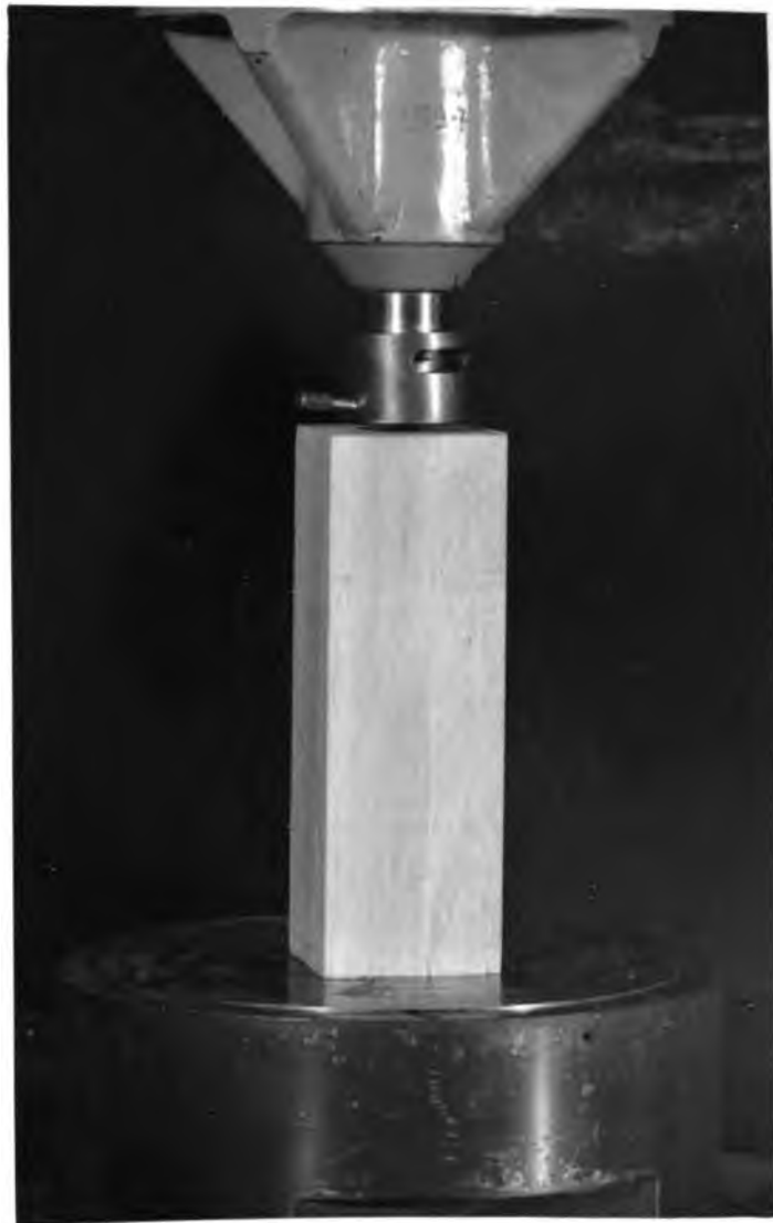
Fot. 7. Instrumento especial y probeta sometida a la prueba de dureza.
