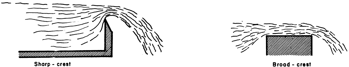
Figura 10: Diagramas esquemáticos de dos tipos de salida de estaciones de aforo ( broad-crested weir y sharp-crested weir ).
