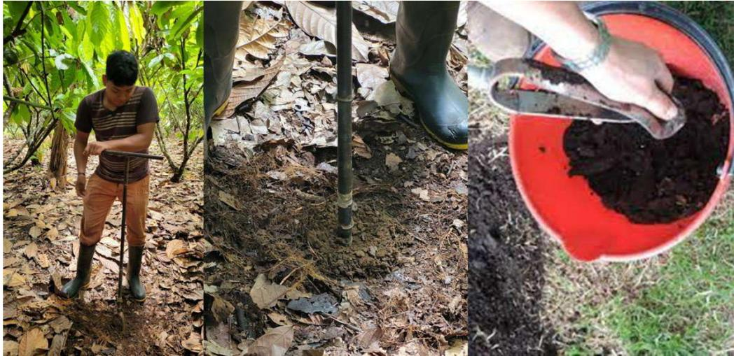
*Figura 30 Proceso de toma de muestra de suelo con barreno*
