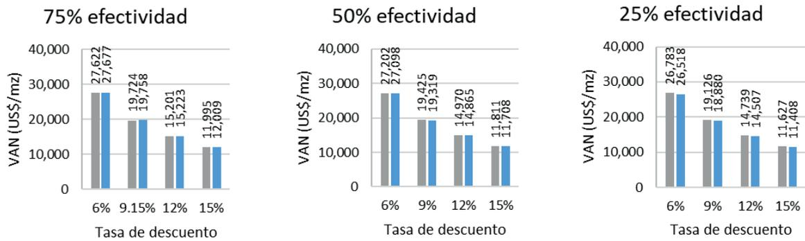
**Figura 7.** Análisis de sensibilidad para el modelo Techo con Sistema Huerto/Patio según diferentes niveles de efectividad de las obras de cosecha de agua y distintas tasas de descuento
