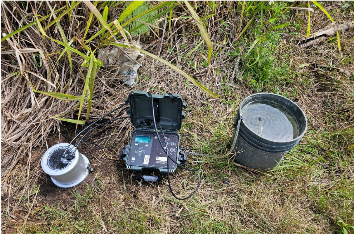
Figura 9. Instalación en campo del infiltrómetro para la medición de la conductividad hidráulica saturada (Kfs).
