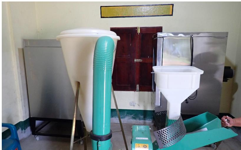
**Figura 18:** Máquina de molido de la semilla de ramón en FORESCOM.
