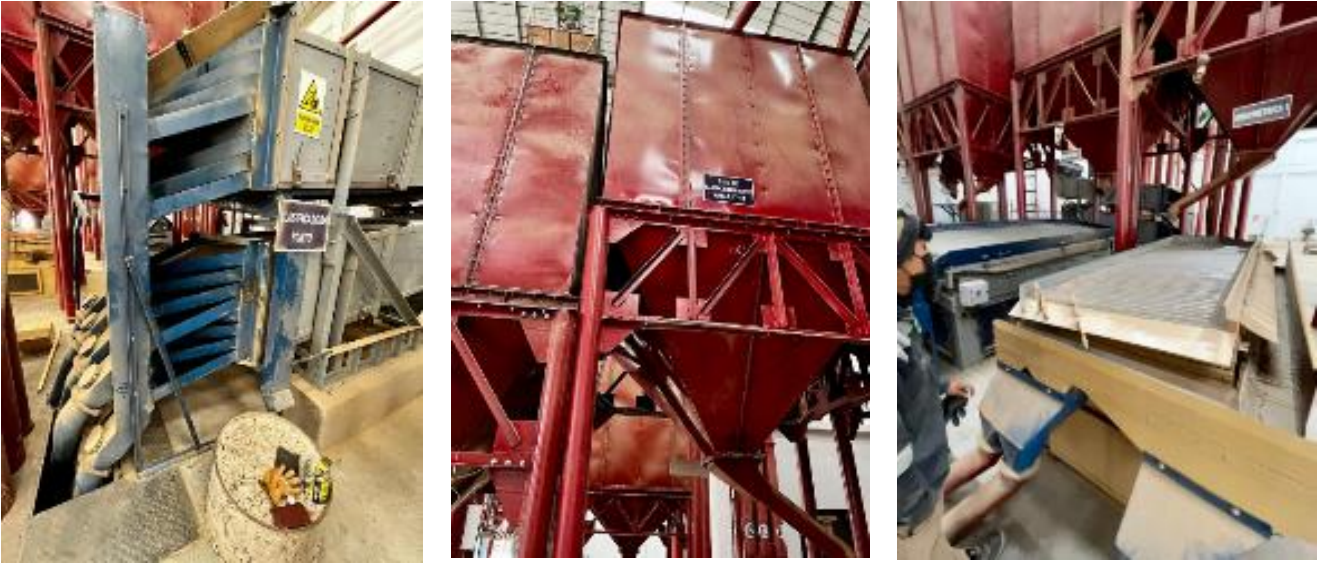
Figura 36: Clasificación por mallas y gravimétrica Fuente: Propia.
