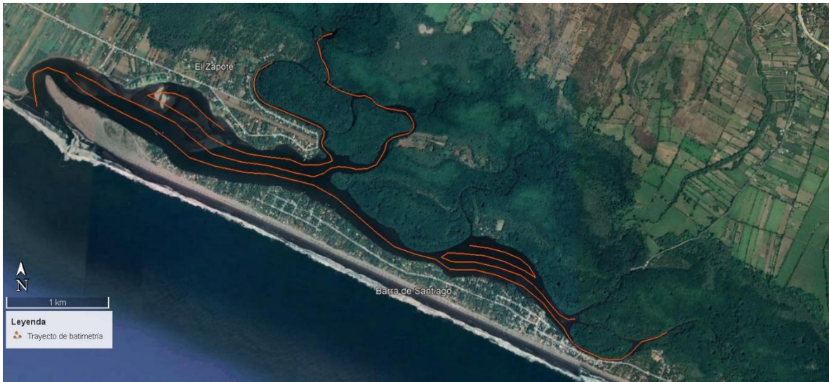
Figura 4. Propuesta de transectos para realizar la batimetría del Manglar Barra de Santiago. Imagen de Google Earth.
