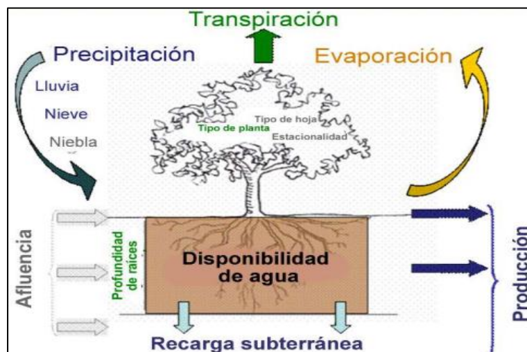
Figura 4. Diagrama conceptual del balance de agua utilizado en el modelo anual de producción de agua
