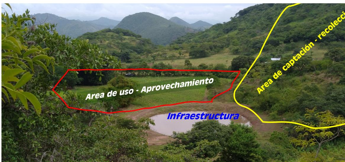
**Figura 4.** Componentes de un sistema de cosecha de agua de escorrentía
