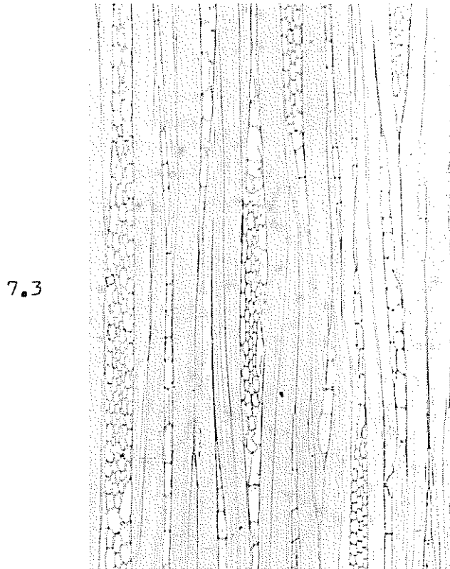
Fig. 7 Características microscópicas de la madera de Laetia procera (Poepp. et Endl) Eichler 7.1 Corte transversal. 7.2 Corte radial. 7.3 Corte tangencial.
