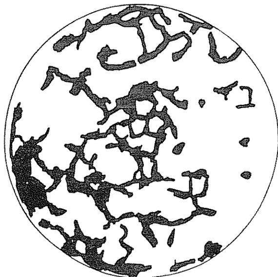
Fig. 1. Secciones de flujo preferencial, marcadas por el tinte Rodhamina B, en muestras sin disturbar contenidas en los cilindros.
