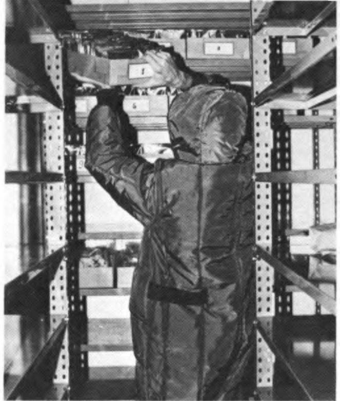
Cámara fría a -20^{\circ}\text{C} para almacenamiento de semillas a largo plazo en sobres de aluminio/plástico.
